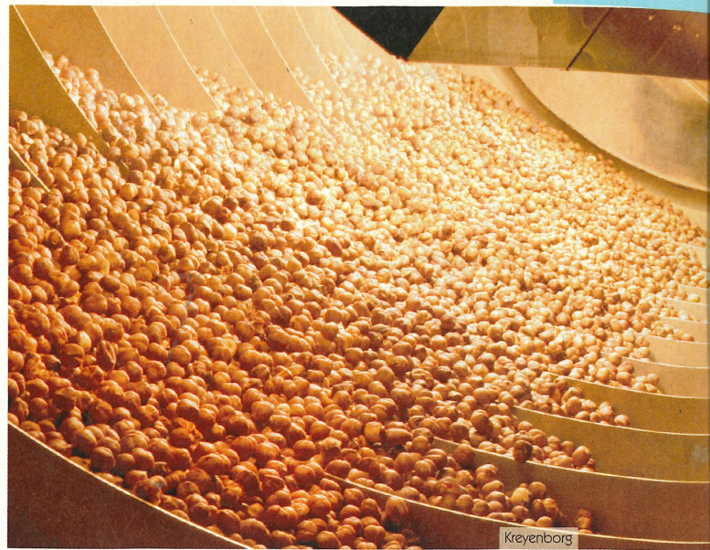
Aufgrund der permanenten Durchmischung des Röstguts entsteht ein gleichmäßiges Ergebnis.
